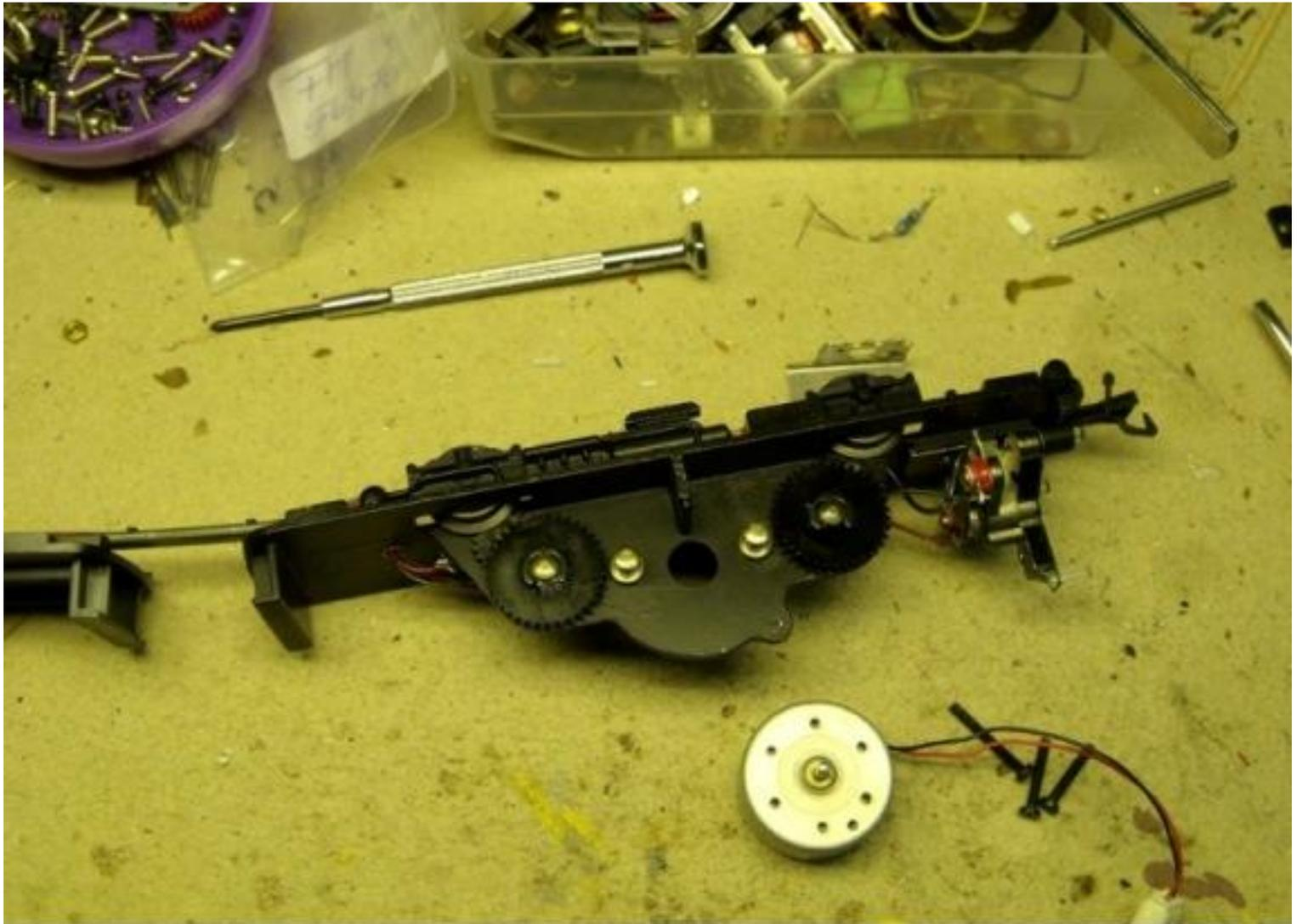
Die großen Zahnräder sind abmontiert um Löcher für die Befestigung zu bohren.
