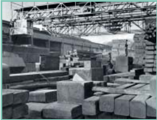
Oben. Das Rohstahllager einer Hammerschmiede. Hier lagern Knüppel, Brammen und Profilstähle, die für die Produktion der Lokomotiven benötigt werden.
